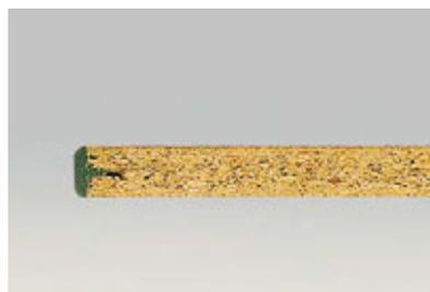
Sezione del piano tavolo con il bordo arrotondato di altezza mm. 19,6 e spessore mm. 5 di pvc morbido
